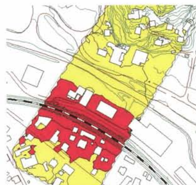
2) Eksempel på støykart med gul og rød sone rundt en sterkt trafikkert jernbanelinje.
