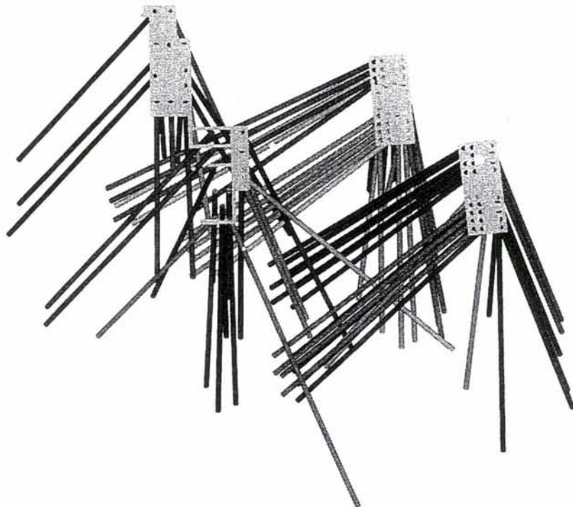
Figur 5 3D modell av pelegrupper for akse 5 og 6, akse 5 er til venstre
