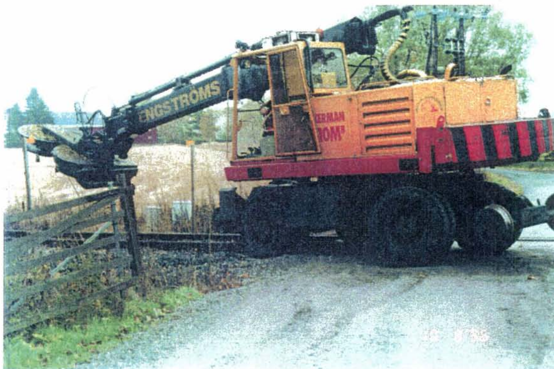
Figur 16. ÅKERMANN FW 2000 WA bom med Rajko ryddeaggregat.
