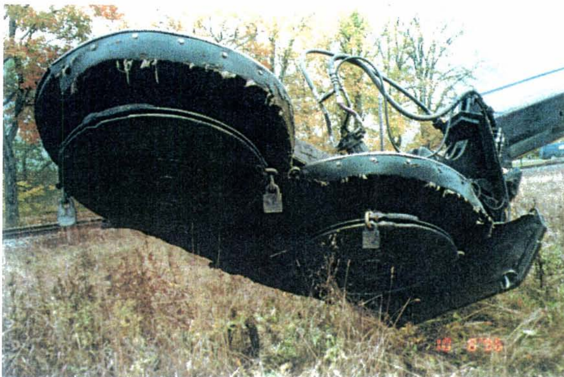
Figur 11. Raijko ryddeaggregat. Se «slagere» ytterst på kjettingleddene.
