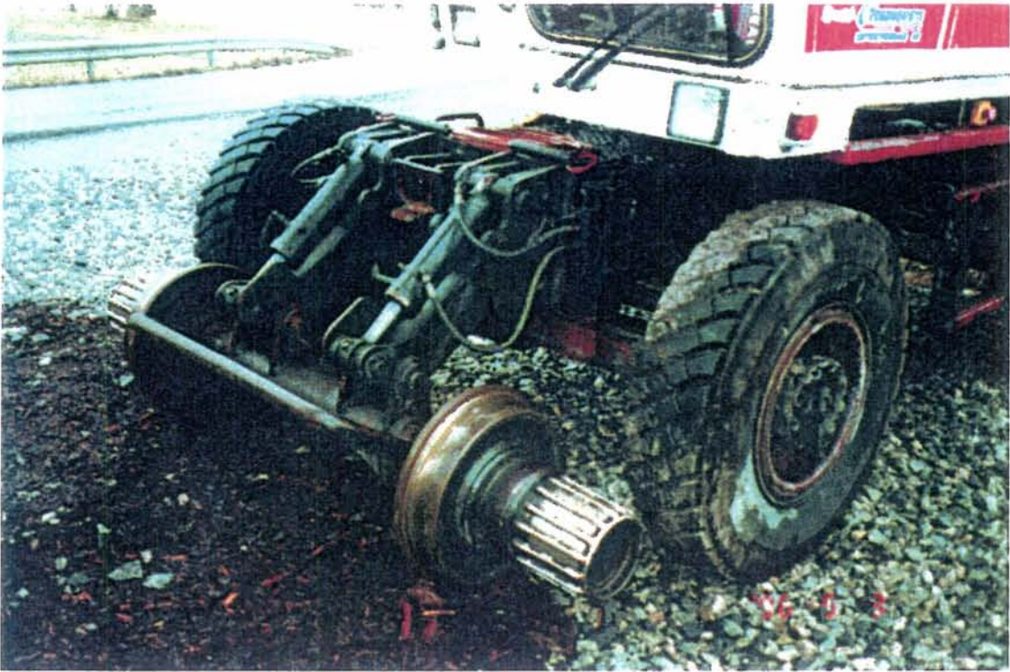
Figur 13. Aksling som svinges inn under gravemaskinen. Både styring og framdrift via akslingene.
