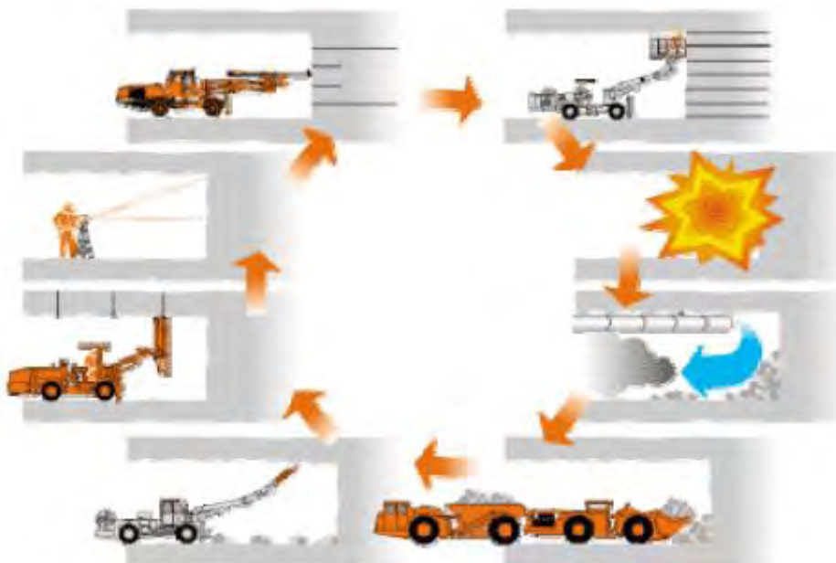
Figur 51: Bore- og sprengesyklus (Sandvik Tamrock Corp., 1999)
