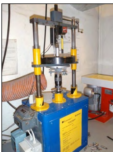
Figur 8: Venstre bilde viser knusing av prøvemateriale. Høyre bilde av apparatur for å beregne Sievers J-verdi som brukes for å finne DRI.
