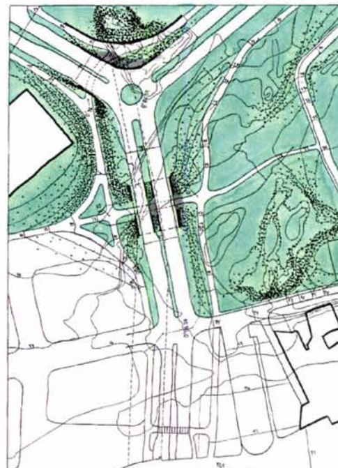
Illustrasjon 14 (til venstre): Kryssing mellom grøntdrag og vei ved hovedkrysset. Forslag til løsning i KDP / forslag til reguleringsplan for ny Snarøyvei.
