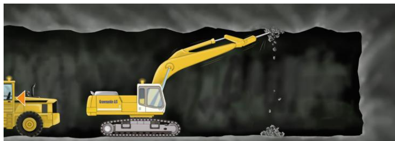
Figur 28: Del 4 Syklus: Rensk. Illustrasjon hentet fra (Statens Vegvesen, 2010).
