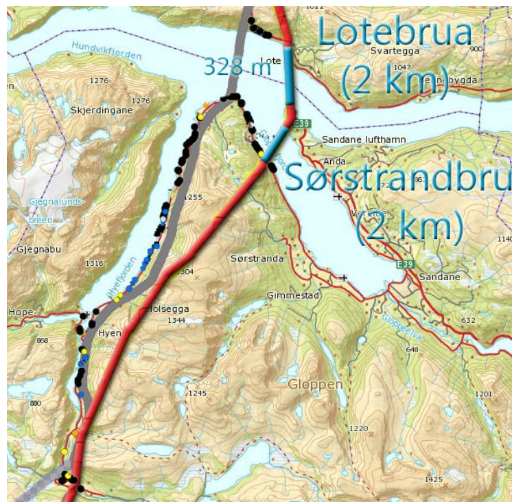
Figur 19: Skredhendelser langs E39 sør for Hundvikfjorden. Gammel trasé markert i grått, ny trasé markert i rødt.
