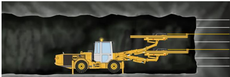
Figur 25: Del 1 syklus: Boring. Illustrasjon hentet fra (Statens Vegvesen, 2010).
