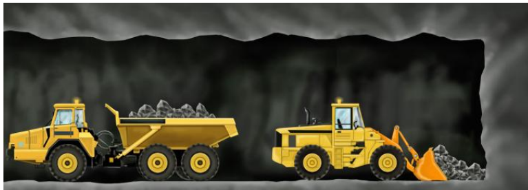
Figur 27: Del 3 Syklus: Lasting og transport av sprengte masser. Illustrasjon hentet fra (Statens Vegvesen, 2010).
