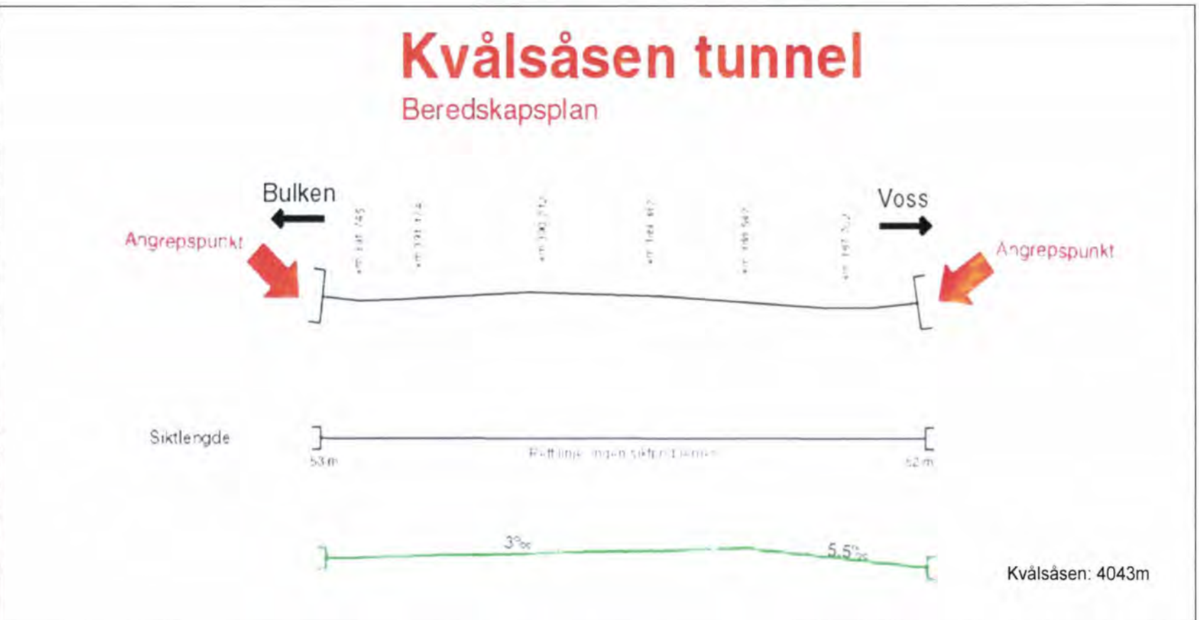
Figur 19: Kvålsåsen tunnel - særskilt brannobjekt, beredskapsstegning.
