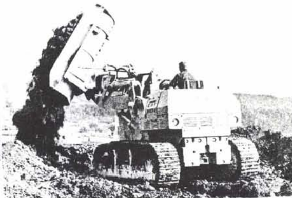
Fig. 22. Beltetraktor med sidetippende skuff. Fronttippende skuff er mere alminnelig.
