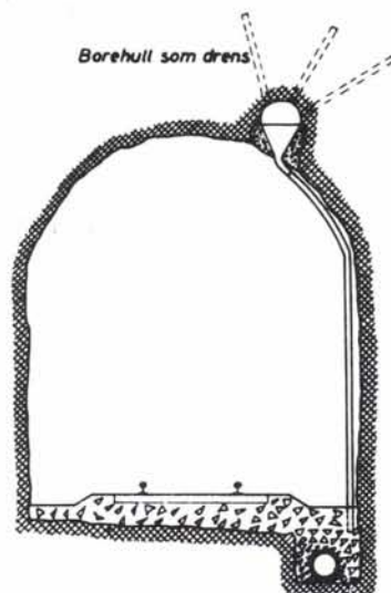
Fig. 79. Bortledning av lekkasjevann.
