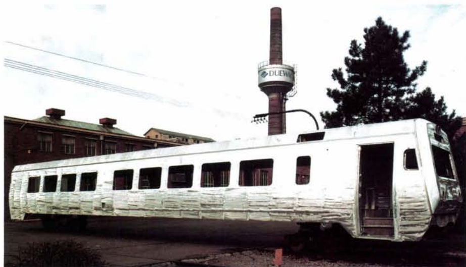
Slik ser skjelettet ut til de nye diesel-elektriske motorvognene som er under bygging i Tyskland. Vi får 15 slike to-vogns sett som skal settes inn på Rørosbanen og Nordlandsbanen.
