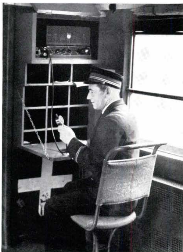
Konduktørrom med mikrofon og forsterker.
