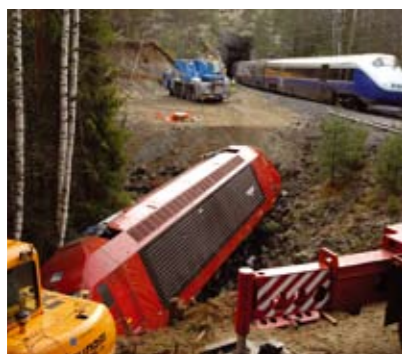
Lokomotivet stanset i et bekkefar 7 meter under sporet etter å ha kjørt inn i et ras ved Flå på Bergensbanen i november 2006. Foto: Øystein Grue
